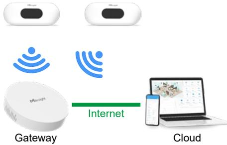
Zur Übertragung der Messwerte verwendet der Raumklima-Sensor den LoRaWAN Standard. Die Daten werden so kabellos an ein separat erhältliches Gateway übertragen, welches dann über Internet die Daten in einer Cloud speichert. So sind die Daten mit Statistiken von überall für Sie abrufbar.
